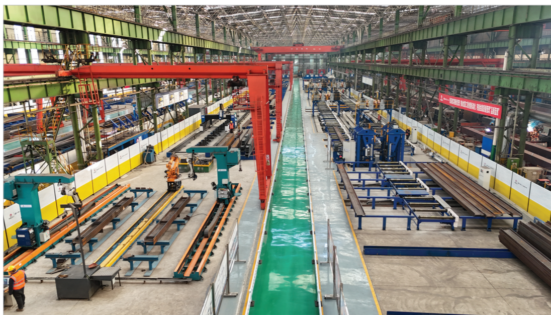
图为中国二十二冶打造的国内首条全自主可控的钢结构智能制造生产线。(中国二十二冶供图)
